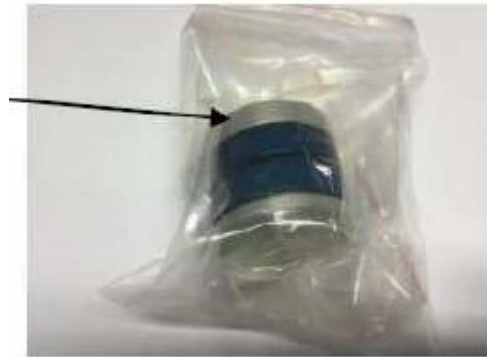
Exemple de filtre « d'ambiance » contenu dans un étuis sous double sac étanche
