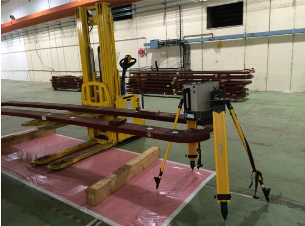
Mesure par spectrométrie gamma in situ à l'aide du détecteur HPGe Falcon\* collimaté sur le point le plus chaud de chacune des 12 bobines
