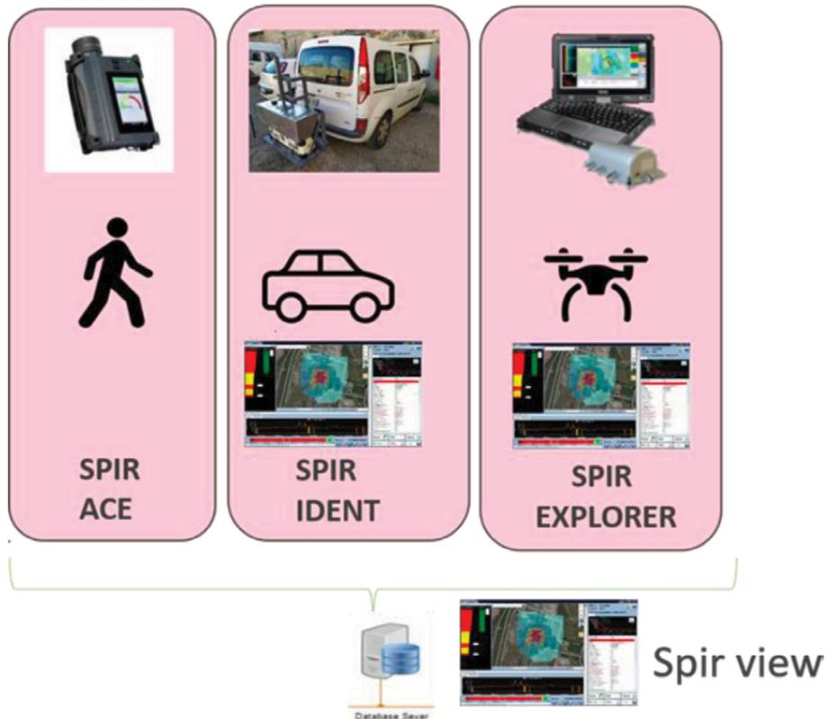
Sur **SPIR-View** il est possible de voir plusieurs appareils de détection simultanément. Toutes les informations sont directement envoyées sur un serveur via une connexion 4G, ce qui permet de visualiser toutes les données en direct à partir d'un seul et même PC d'acquisition.
