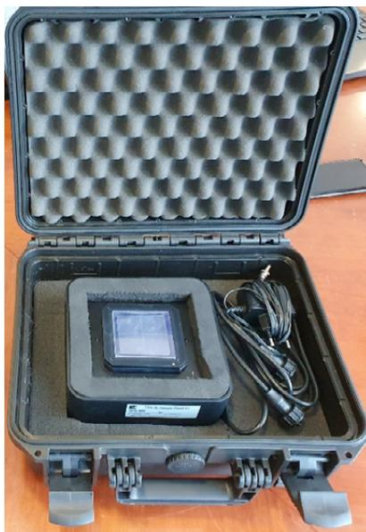
Très sensible : Des traces d'Uranium inférieures au  $\text{Bq}/\text{cm}^2$  ont pu être mesurées et cartographiées sur du béton avec un temps d'exposition de 3 minutes pour chaque mesure. Des mesures de radionucléides beta sont également possibles avec une bonne sensibilité. Des mesures d'échantillons tritiés ont également été réalisées avec le détecteur MAUD dans le cadre du projet Européen TRANSAT (Transversal Actions for tritium, 2016-2021).
