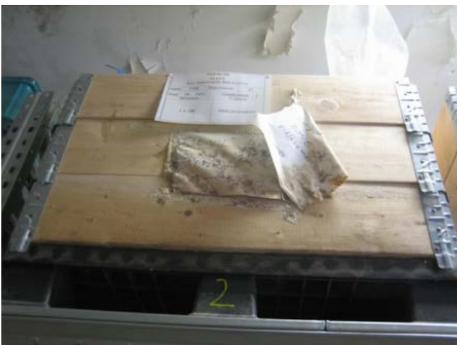
Dégradation des fiches d'identification par les moisissures
